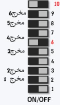
يتم تشغيل المخرج بعد انقطاع التيار الكهربائي
